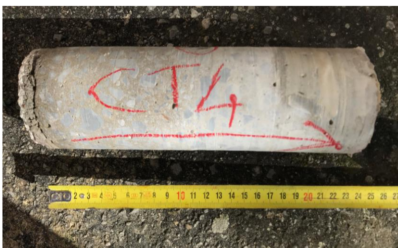
Figura 5.8 – Verifica della profondità di Carbonatazione campione CT4
