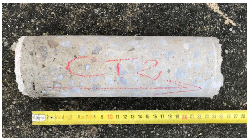
Figura 5.6 – Verifica della profondità di Carbonatazione campione CT2
